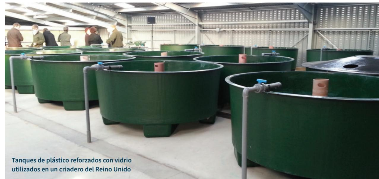
Tanques de plástico reforzados con vidrio utilizados en un criadero del Reino Unido
